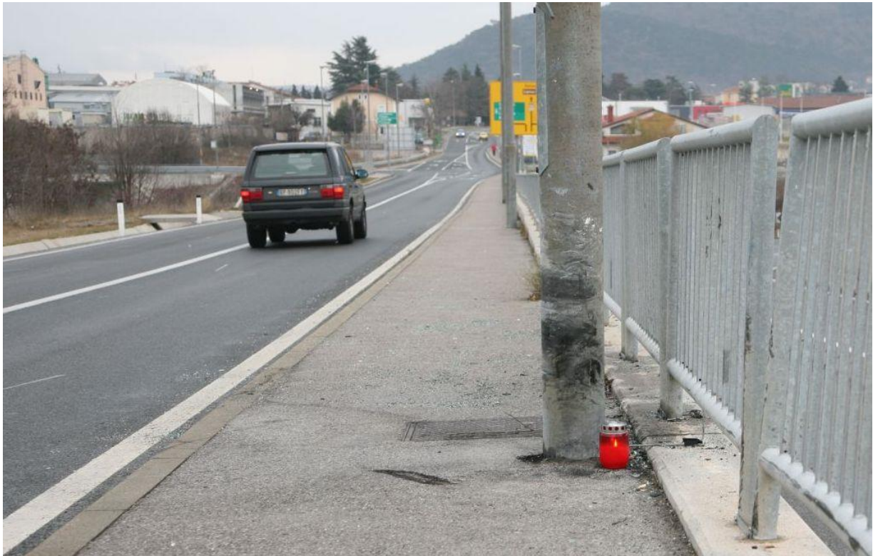
Nesreča s smrtnim izidom v Sežani, januarja 2012. Trk v drog javne razsvetljave izdelane po nezavezujočem evropskem standardu EN13201 je povzročil smrt voznika iz Italije. Ta del ceste bi moral biti neosvetljen. Če bi osvetlili manj (in v nasprotju s standardom) z malim drogom višine 4 m, bi voznik verjetno preživel.
