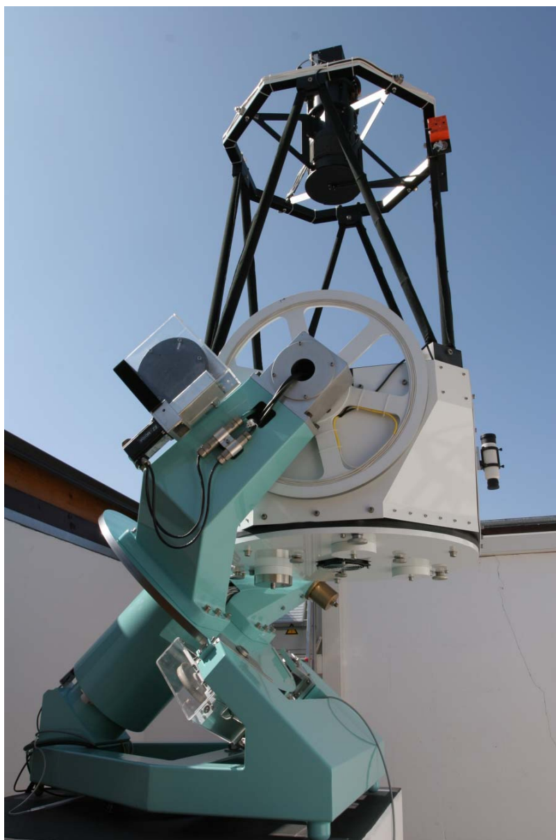
Slika 2: 60-cm internetni robotski teleskop Cichocki podpira preko 100.000 vrstic programske opreme za delovanje teleskopa in samodejno iskanje novih asteroidov ter oddaljenih eksplozij v vesolju, kot so supernove, spremenljivke ter optični afterglow-i izbruhov žarkov gama. Projekt teleskopa in programska oprema je v celoti delo sodelavcev observatorija.
